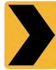
INDICADOR DE CURVA PELIGROSA: Guía a los conductores de vehículos en su desplazamiento por una curva pronunciada con respecto a la geometría predominante.
