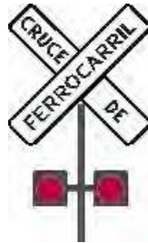
SEMÁFORO PARA CRUCES CON VÍAS FÉRREAS: Previenen a los conductores de vehículos de la aproximación de un cruce a nivel con una vía férrea.
