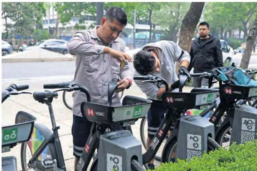
El personal acude a las cicloestaciones a reparar las unidades y tarda alrededor de 15 minutos. Realiza reemplazo de sillón, campanilla y ajustes a la liga y freno.
