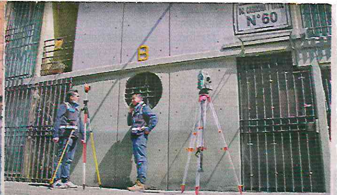
Topógrafos realizan estudios en la torre Tauro, la cual tiene una inclinación hacia la Calle Dr. Liceaga
