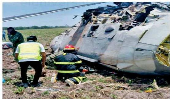
El fabricante del helicóptero Black Hawk analizó la caja negra de la aeronave y determinó que la causa de la caída fue falta de combustible.
