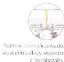
Separación insuficiente de vigas entre ellas y respecto a los cabezales
