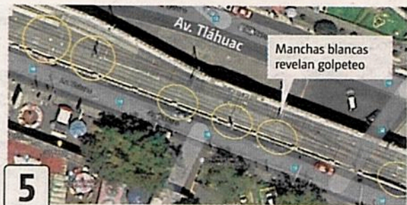
Evidencias de golpeteos en vía Por mantenimiento deficiente
