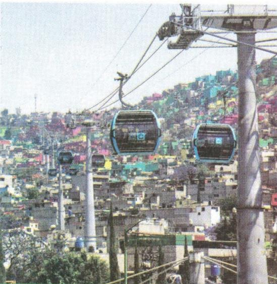
**ESTRENO.** Las cabinas viajan a una altura aproximada de 35 metros como máximo desde el piso, cuentan con ventilación, iluminación exterior e interior, así como conexión gratuita a internet.
