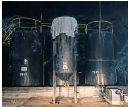
Los contenedores metálicos eran conectados con mangueras a la minirrefinería para producir diesel.
